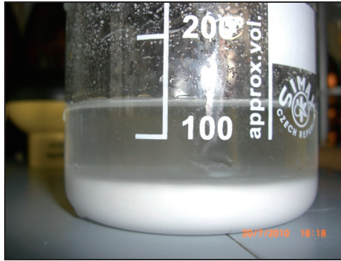
Rysunek 3. Struwit wytworzony w warunkach laboratoryjnych Figure 3. Struvite produced in the laboratory
