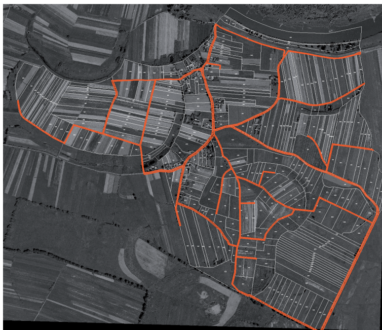
Rys. 3. Nowy układ gruntowy wsi Barczków wraz z identyfikacją sieci transportowej (działki wyróżnione kolorem czerwonym)
