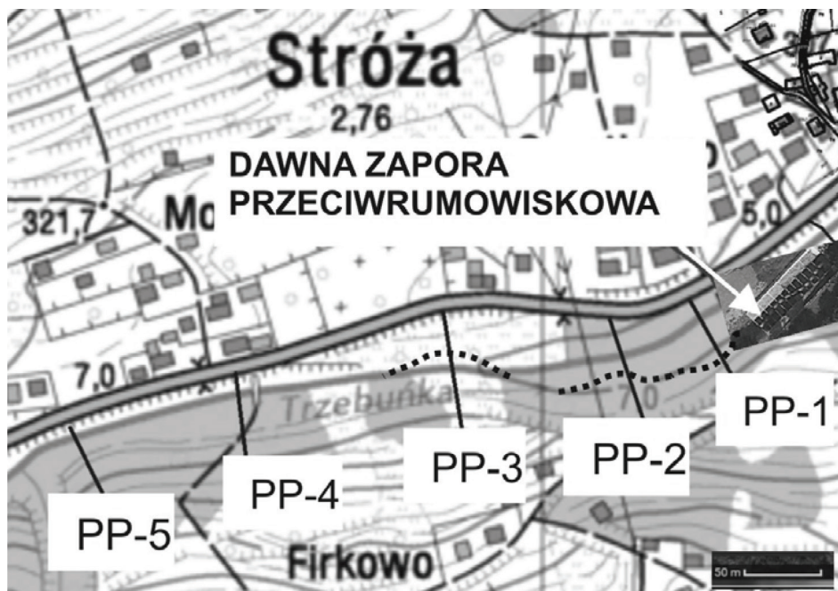
Rysunek.1. Lokalizacja zapory i przekrojów badawczych na potoku Trzebunka, z zaznaczonymi miejscami występowania intensywnej erozji bocznej (linia czarna przerywana).
