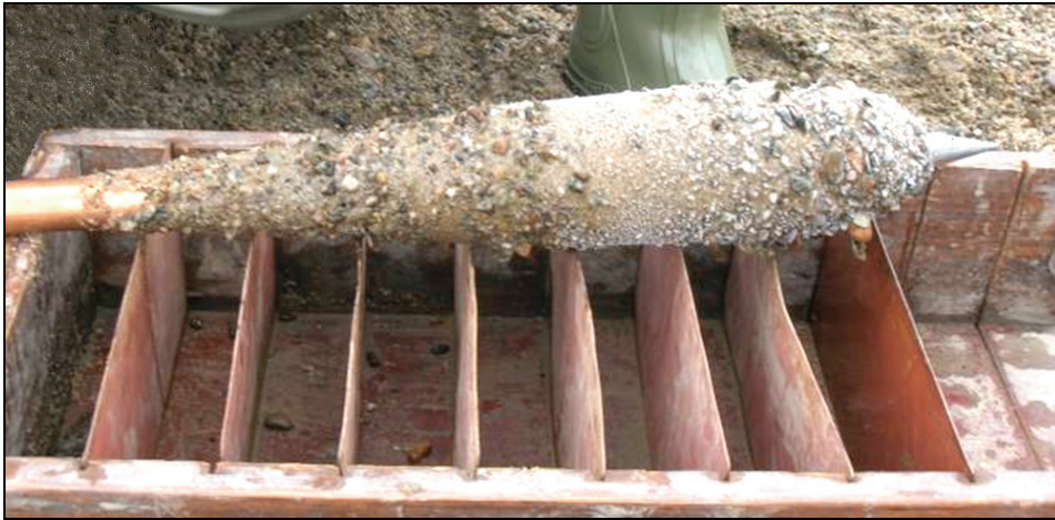
Fotografia 2. Zamrożona próba rumowiska, rzeka Raba, km 0+560, lipiec 2005 Picture 2. Freezed sample of the bed material, Raba River, km 0+560, July 2005
