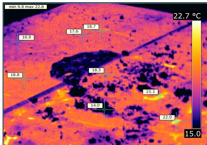
**Fotografia 2.** Powierzchnia ziemnego biofiltra – fotografia termowizyjna
