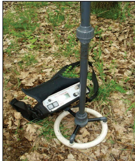
Rysunek 2. Miernik poziomego rozkładu podatności magnetycznej
