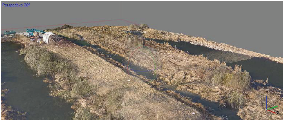
Rysunek 10. Model 3D wykonany na podstawie zdjęć z UAS. Figure 10. 3D model of terrain created using UAS pictures.
