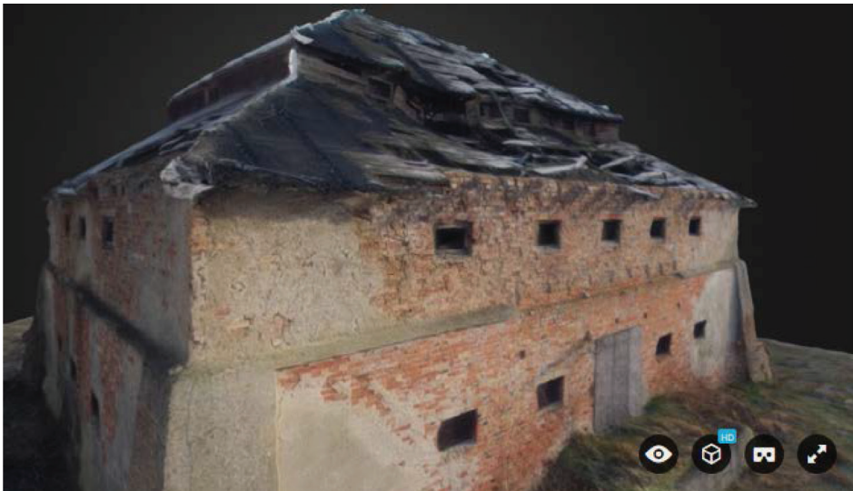
Rysunek 11. Spichlerz w Grzecznic (Zachodniopomorskie) opracowany na podstawie zdjęć z kamery GoPro zamontowanej na UAS, źródło: Antosik A., opublikowano na: https://sketchfab.com/models/7ccd952548364e0fa599022fe80669fd (dostęp na dzień 1.04.2016r).
