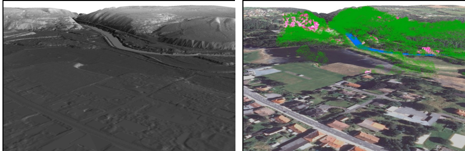
Rysunek 2. Numeryczny model terenu bez i z warstwami pokrycia terenu Figure 2. Digital Terrain Model without and with land cover layers
