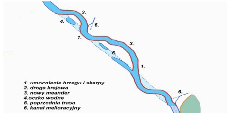
Rysunek 5. Propozycja rewitalizacji odcinka w km 70+900 ÷ 69+860 Figure 5. River reach (km 70+900 ÷ 69+860) – suggestion of revitalization
