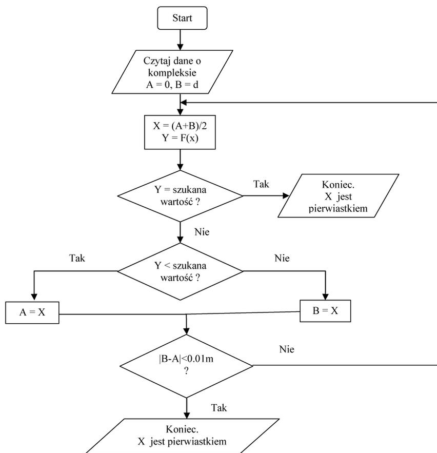
**Rysunek 2.** Poszukiwanie granicy – schemat blokowy
