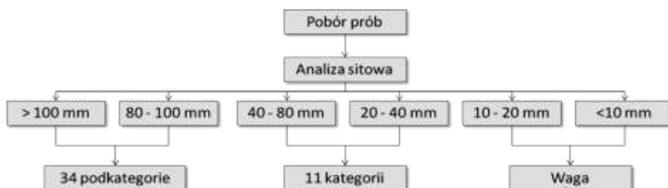
Rysunek 5. Schemat badań składu odpadów metodą SWA Tool
