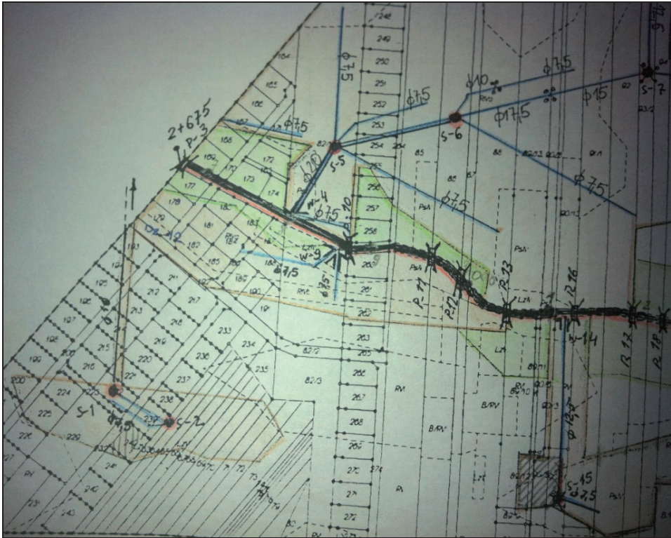
Rysunek 4. Część kartograficzna ewidencji wód, urządzeń melioracji wodnych oraz zmeliorowanych gruntów – mapa ewidencyjna w skali 1:2000
