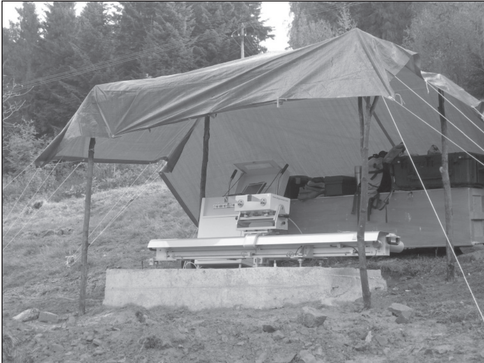
Rysunek 3. Radar IBIS L podczas pomiaru osuwiska w Milówce (źródło: opracowanie własne)
