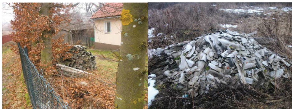
Rysunek 2. Niewłaściwy sposób magazynowania azbestu – obiekty z I stopniem pilności usuwania
