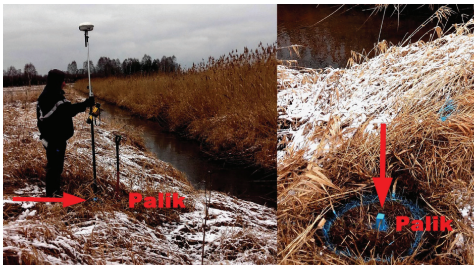
Rysunek 3. Przykład określenia linii brzegu przez geodetę w terenie.
