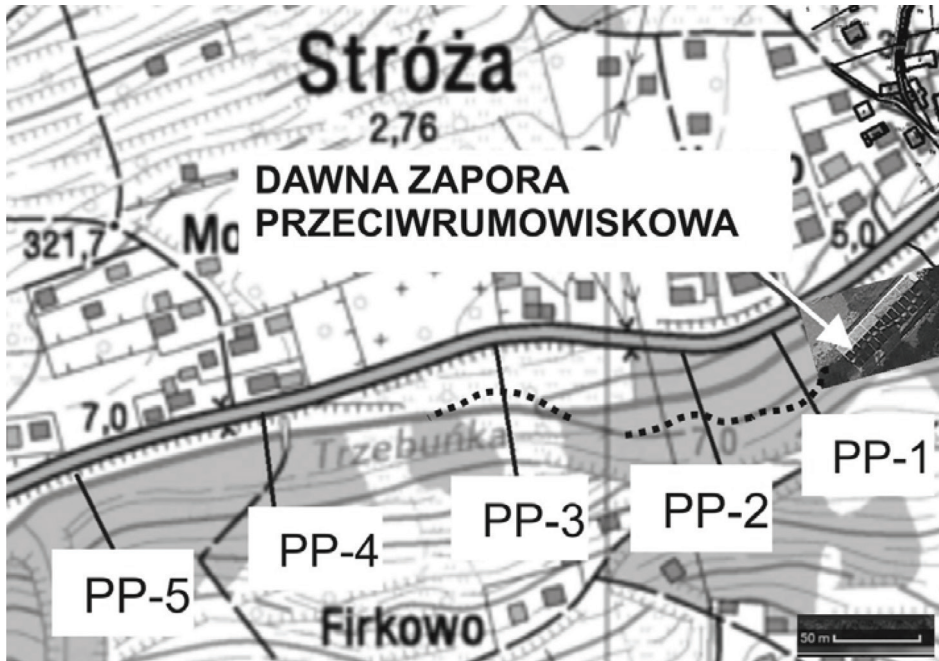
Rysunek.1. Lokalizacja zapory i przekrojów badawczych na potoku Trzebuńka, z zaznaczonymi miejscami występowania intensywnej erozji bocznej (linia czarna przerywana).
